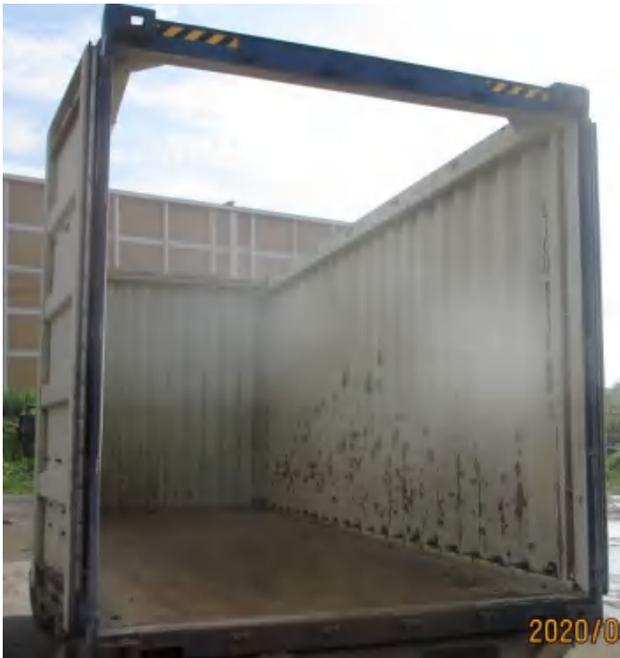
②第二张将有箱号的箱门关闭，另一扇打开，体现箱内状态与箱号间的关联性(第一张照片能反映箱内右侧壁箱号，第二张不须拍摄)。
