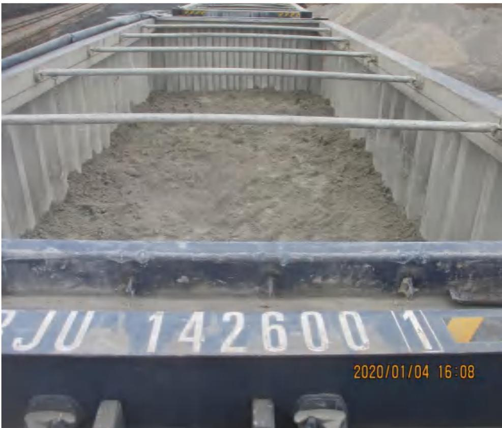
(2) 篷布苫盖后，拍摄两侧篷布苫盖状态，照片要能体现和箱号的关联性（每侧1张，共2
