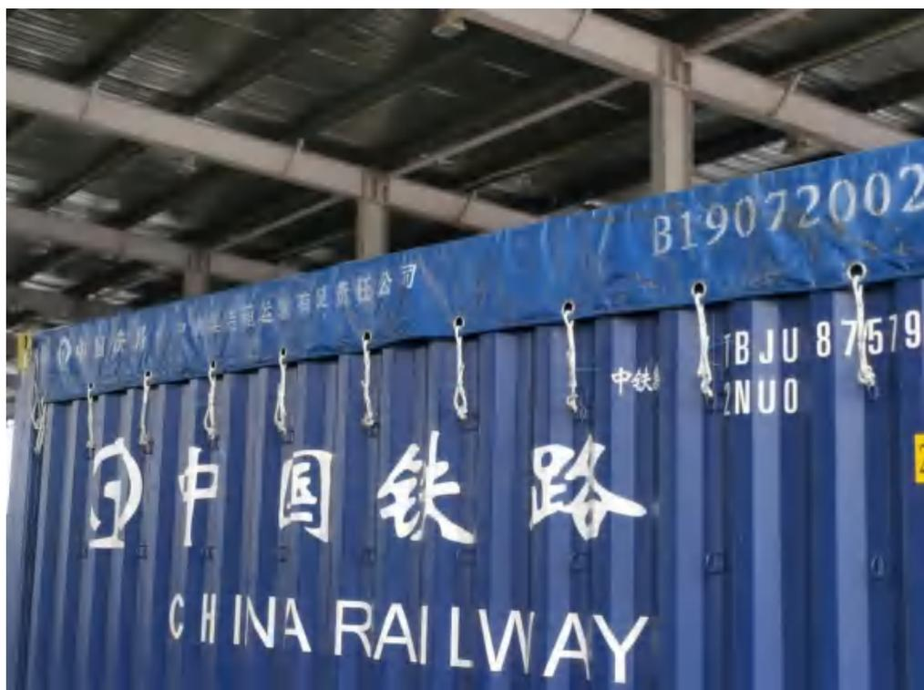
(3) 篷布苫盖后，拍摄箱顶篷布状态及箱顶两端绳圈状态，照片能体现和箱号的关联性（每端 1 张，共 2 张，装卸人员拍摄，货运员审核）
