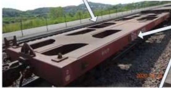
确认车底板上无残货杂物
